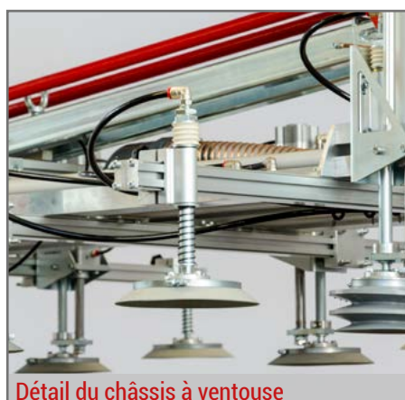
Détail du châssis à ventouse
