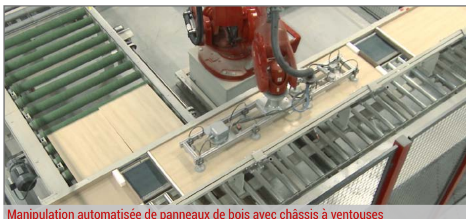
Manipulation automatisée de panneaux de bois avec châssis à ventouses
