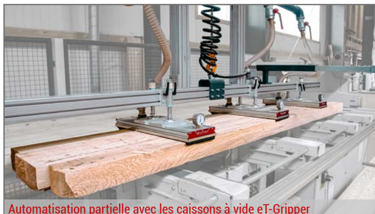
Automatisation partielle avec les caissons à vide eT-Gripper
