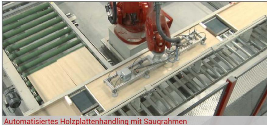
Automatisiertes Holzplattenhandling mit Saugrahmen
