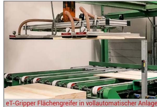
eT-Gripper Flächengreifer in vollautomatischer Anlage
