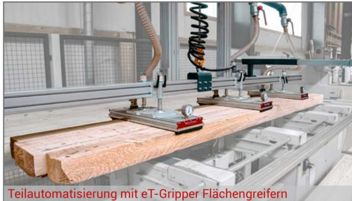
Teilautomatisierung mit eT-Gripper Flächengreifern
